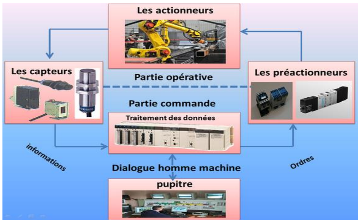
Figure 20: Structure d'un système automatisé
