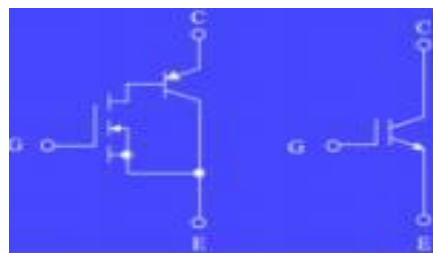
Figure I-28: schéma d'un transistor bipolaire l'IGBT[37]
