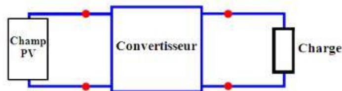
Figure I-31: la position d'un convertisseur [41]
