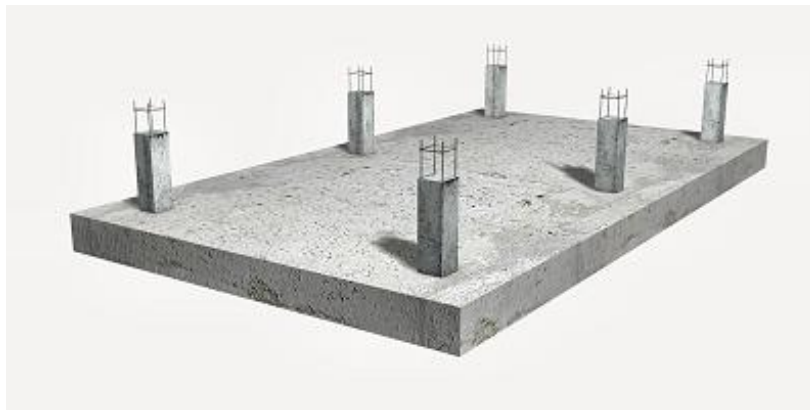
Figure VIII.2. Schéma d'un radier général.
