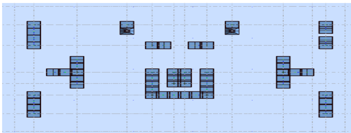
Figure V.3.Disposition des voiles 1 « T=0,54S W=2107,922T ».
