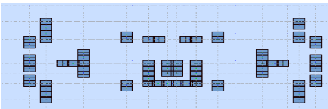
Figure V.4. Disposition des voiles 2 « T=0,54S W=2143,437T ».
