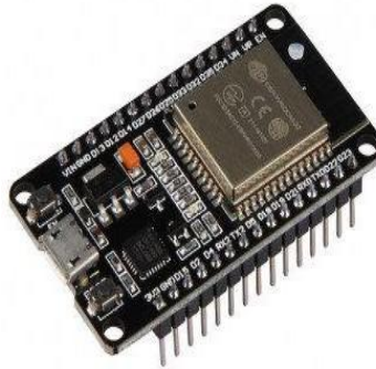
Figure 6 : Carte de développement esp32.[31]
