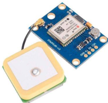
Figure 5 : Module de gps NEO-6M.[30]
