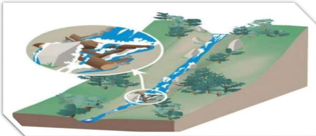
Figure 5 : Embâcle sur un torrent, inondation par crue torrentielle (Hafiane et Benzaid, 2019)
