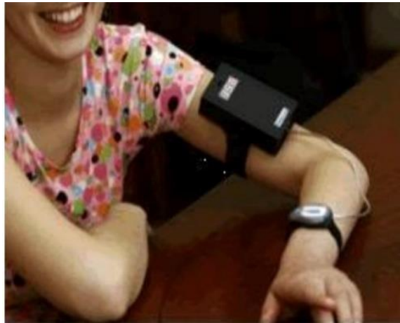
Figure 39: Gluco band utilisant la détection électromagnétique [31]
