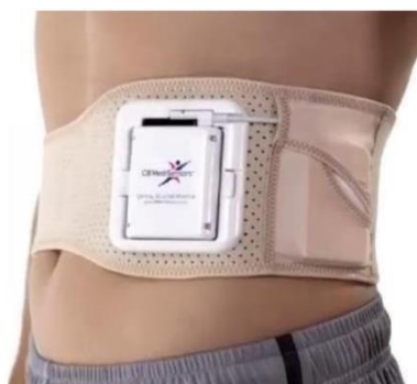
Figure 27: C8MediSensor utilisant la spectroscopie Raman [26]
