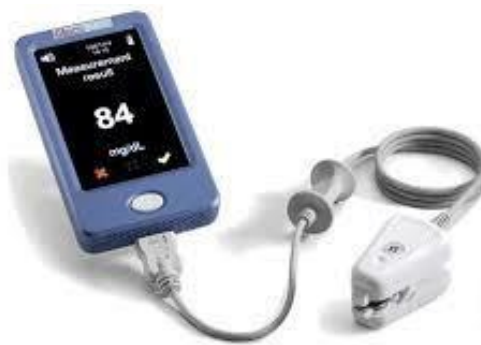
Figure 43: GlucoTrack basé sur l'approche Multisensorielle
