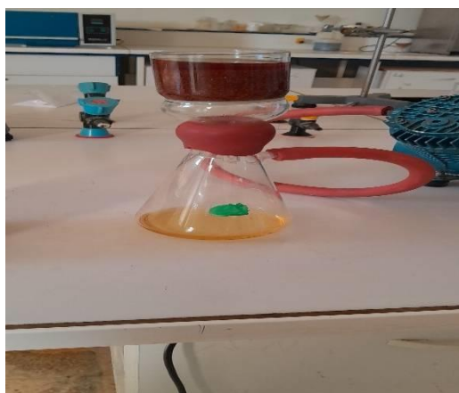
Figure.III. 2. Protocole de filtration sous vide
