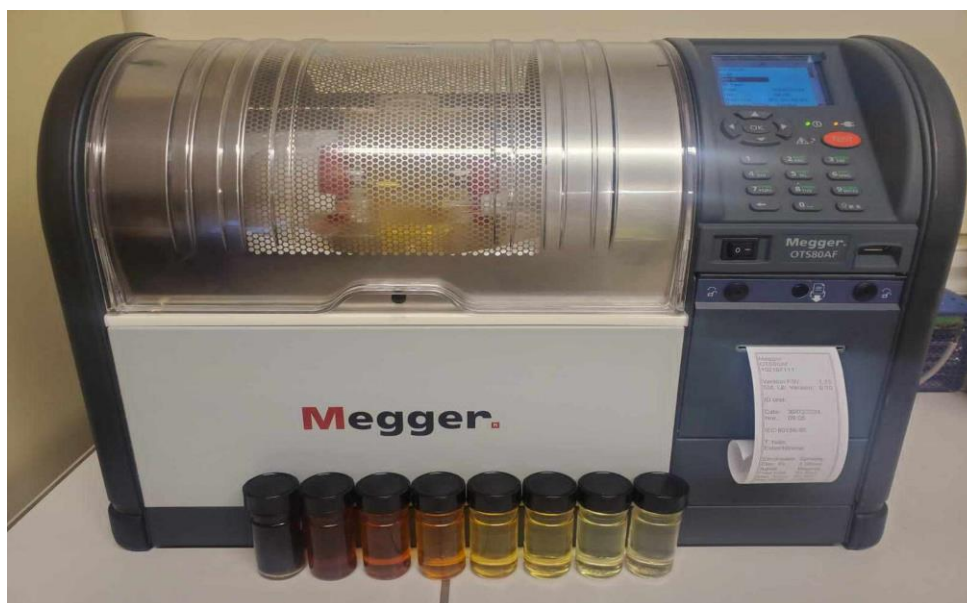
Figure.III.12. Appareil de mesure de la tension de claquage
