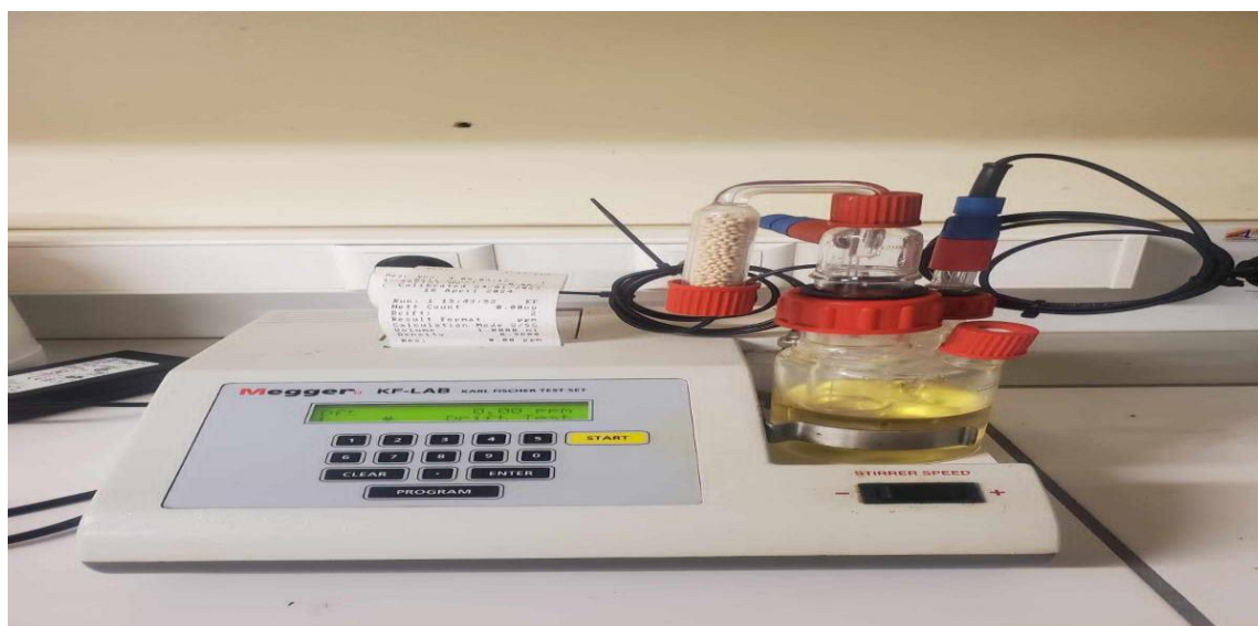
Figure.III.11. Titreur Coulométrique Karl Fisher pour la mesure de la teneur en eau
