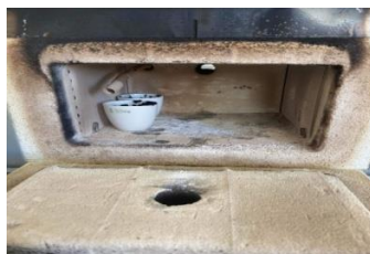
Fig. IV.6 : La calcination dans un four à moufle T=600 °C pendant 3h
