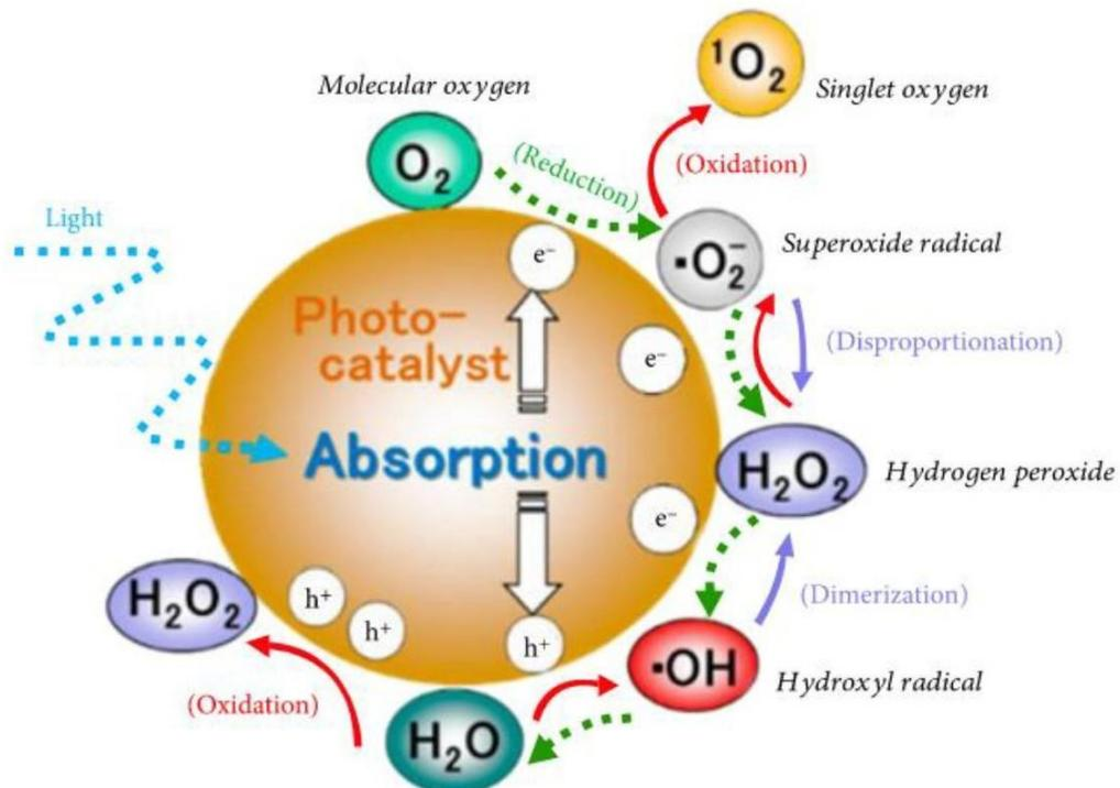
**Figure II-2 :** Illustration schématique du mécanisme de base d'un processus photocatalytique hétérogène sous lumière solaire [55]
