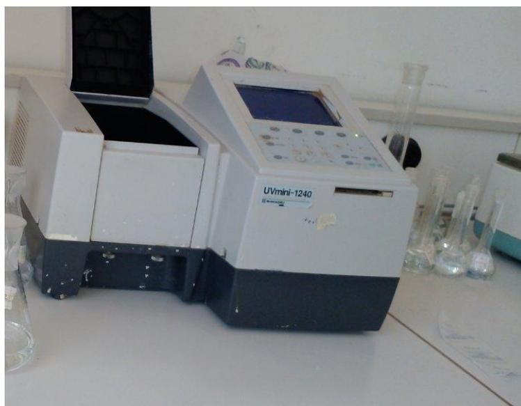
**Figure III-5 :** spectrophotomètre UV-Visible.
