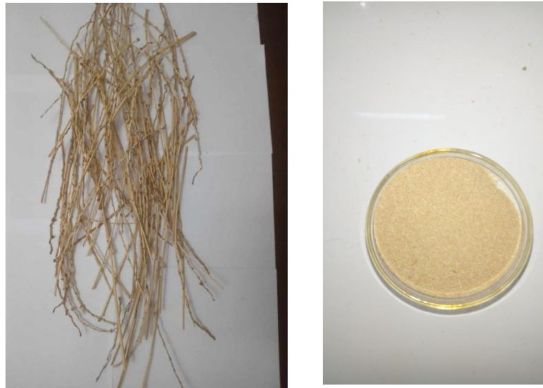
Figure III.4 : Aspect de tige de palmier avant et après broyage et tamisage.
