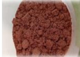
Fig. IV.2 : Poudre de noyaux de dattes après lavage, séchage et broyage.
