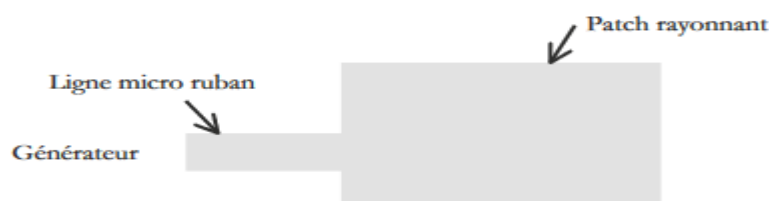
Figure II.5: Alimentation par ligne micro ruban.
