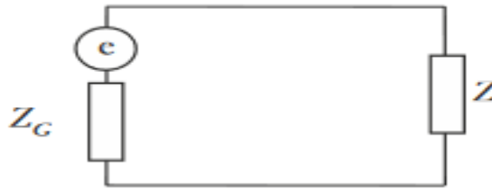
Figure I.7 : Schéma électrique d'une antenne en présence du générateur.
