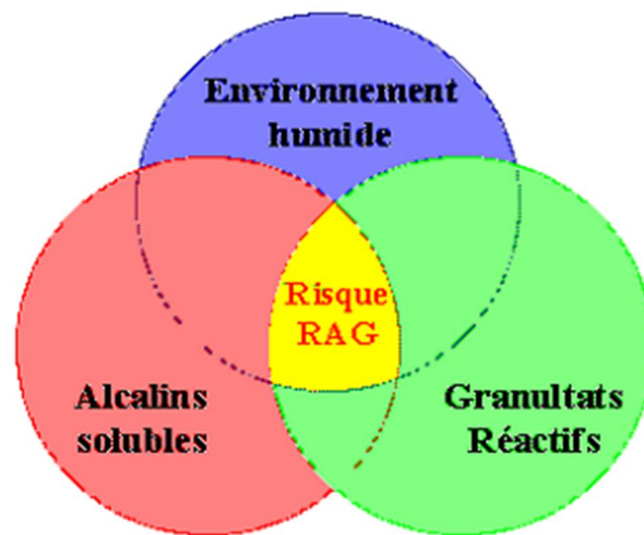
Figure 2.7 : Conditions qui provoquent le risque R.A.G (CETMEF, guide de béton en site maritime, 2008)
