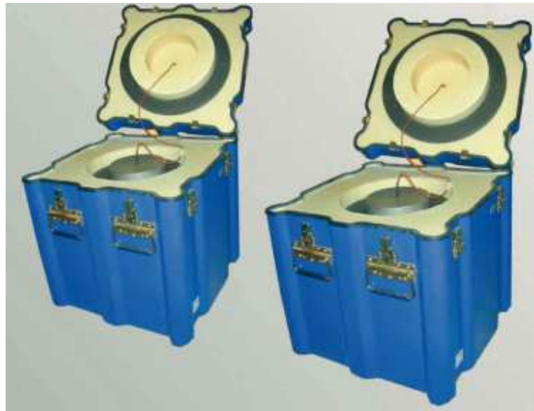
Fig. 1.1 Calorimètre semi-adiabatique utilisé aux éprouvettes de béton, Boulay. C et al (2010).
