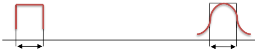
Figure. II.3. Effet de la dispersion chromatique : le signal qui se propage s'élargit.
