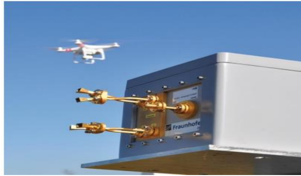
Figure 1.13 : Système de détection de drones par Radio Fréquences [12].
