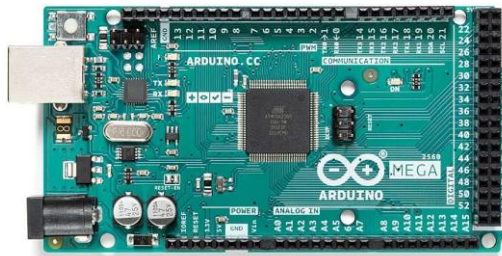
Figure 2.4 Carte Arduino Mega 2560
