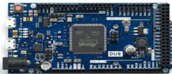
Figure 2.6: Carte Arduino Due
