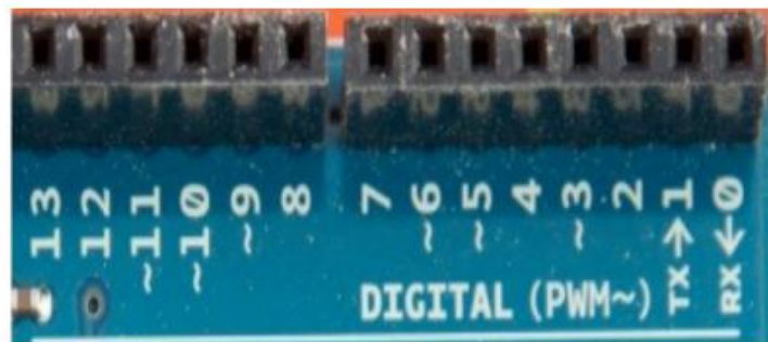
Figure 2.11 : Les Entrées/Sorties numériques 0 à 13
