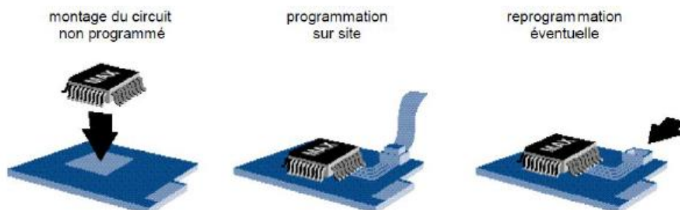
Figure I.15: Reprogrammabilité sur site d’un FPGA
