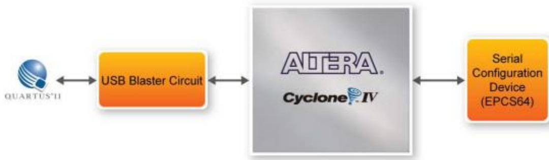
Figure I.12 : Programmation d'un périphérique de configuration série avec une solution de chargeur flash série [I.15].
