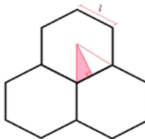
Figure II.10 Cellule élémentaire d'un nida à structure hexagonale régulière.
