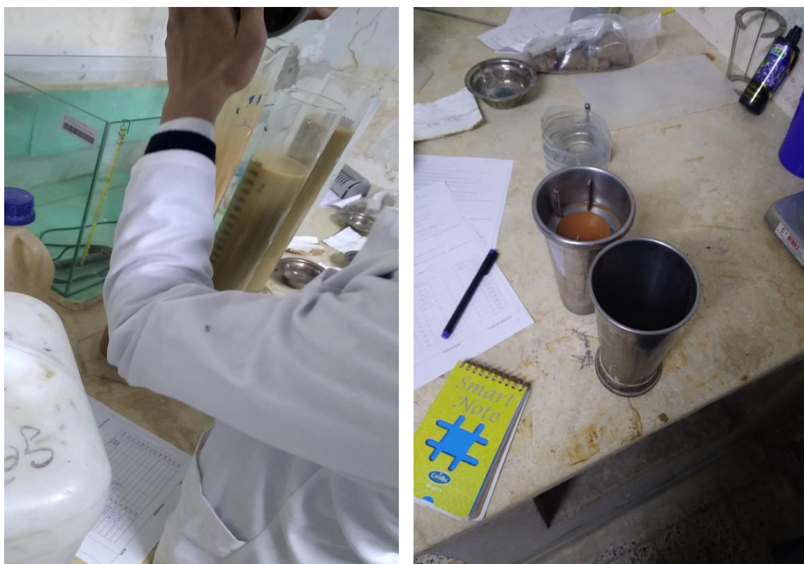
Photo 16 : Essai de sédimentométrie
