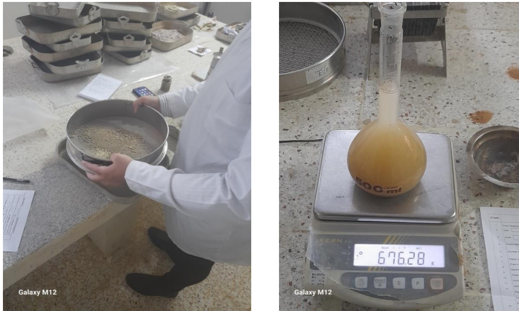
Photo 13 : l'essai au pycnomètre
