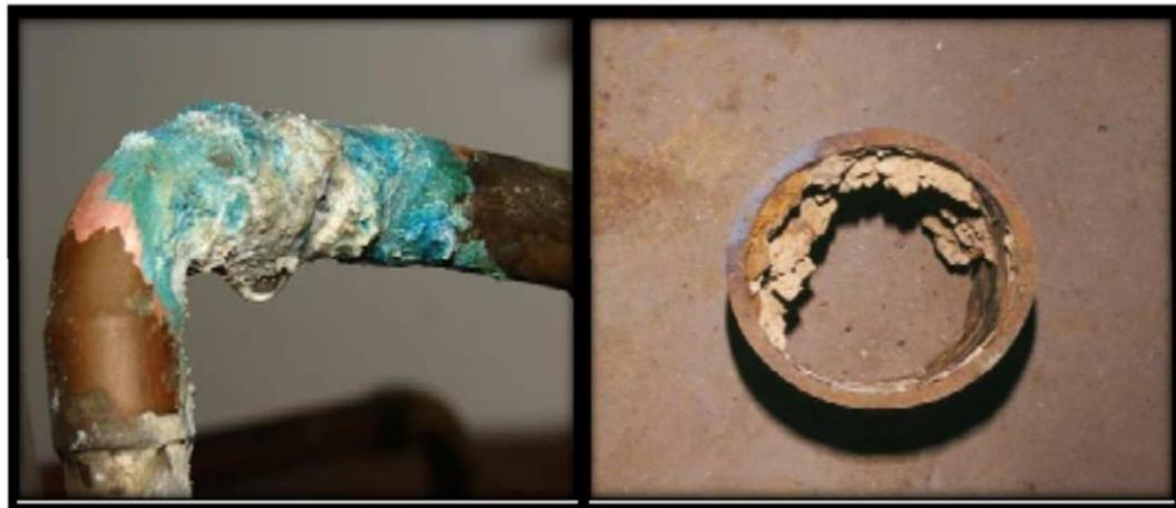
Figure N°35 : La corrosion dans les conduites.
