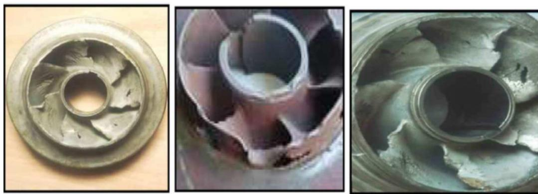
Figure N°13: Photos illustrant le phénomène de cavitation sur pompe centrifuge
