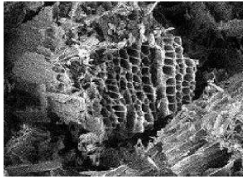
Figure II.1 : Structure du charbon actif vu sous un microscope électronique [17].
