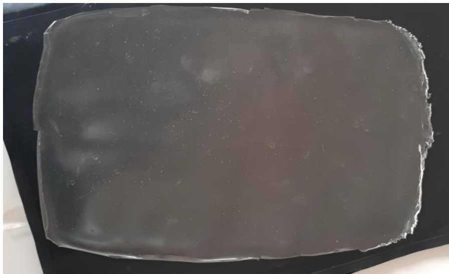
Photo 13: Le film bioplastique obtenu suivant le protocole 3; plastique homogène, souple et résistant.
