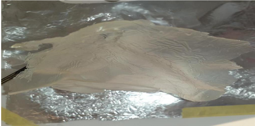
Photo 11: Le film bioplastique obtenu suivant le protocole 1; plastique fragile et cassant.
