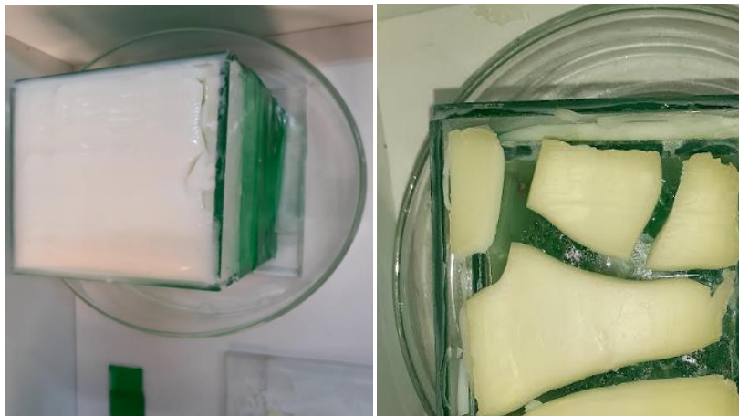
Photo 14: Fissuration et déchirure du film bioplastique.
