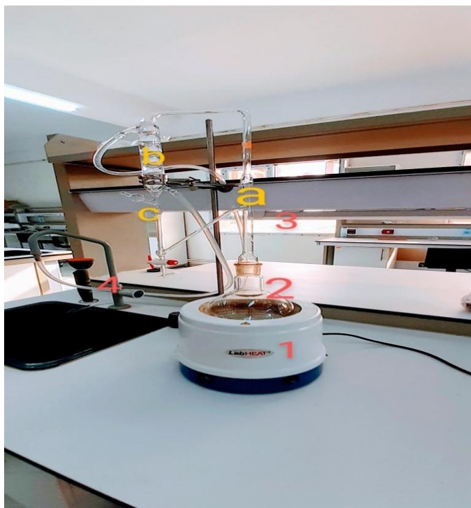
Figure 3: Montage d'extraction d'huile essentielle – Méthode d'hydro distillation.
