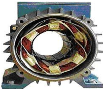
Fig. II.3 stator d'une machine asynchrone
