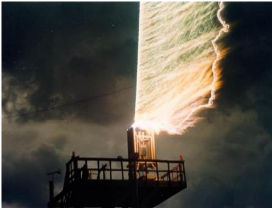
Figure II.7 : Déclanchement artificielle de la foudre [11].
