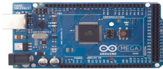
Figure III.6: Carte Arduino Méga 2560 et Carte microcontrôleur ATmega2560.
