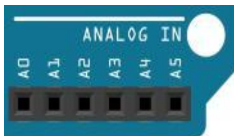
Figure III.5: Les entrées analogiques de la carte Arduino UNO.
