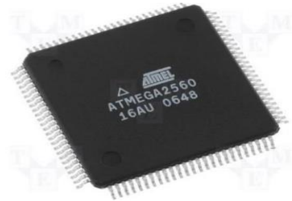
Figure III.6: Carte Arduino Méga 2560 et Carte microcontrôleur ATmega2560.
