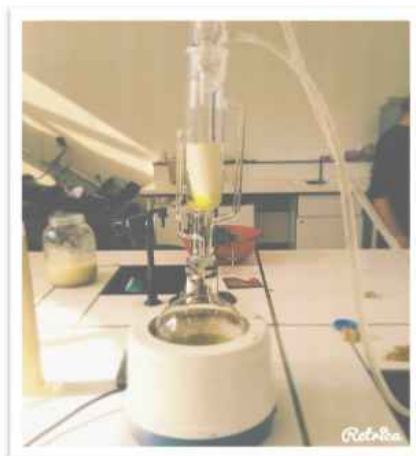
Figure III. 2 : Extraction d'huile Végétale de fruits de Pistacia lentiscus L par Soxhlet
