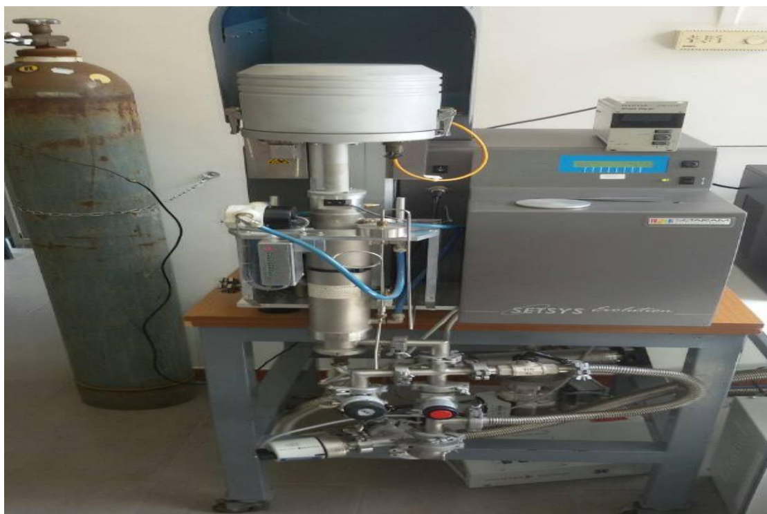
Figure III.6 : Montage des mesures thermique (ATG-DTG) par Setaram Setsys 1200 TG
