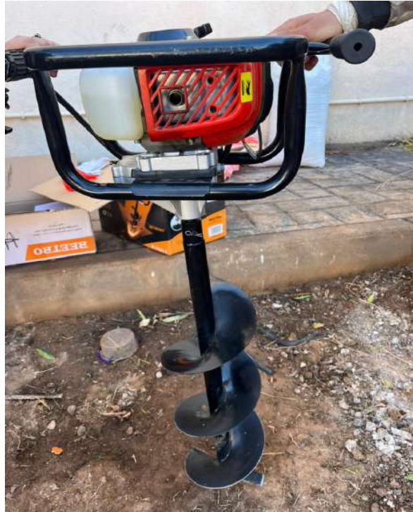
Figure 49: Tête de la foreuse (Cliché Berrehal, 2024)
