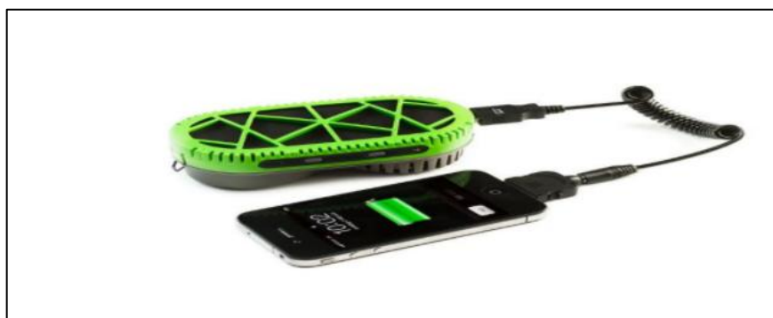
Figure III-13: Un portable chargé par une PAC model POWERTREEK (MyFc). [53]
