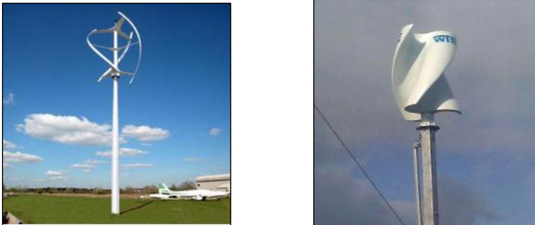
Figure I-15 : l'axe de rotation est vertical.[10]
