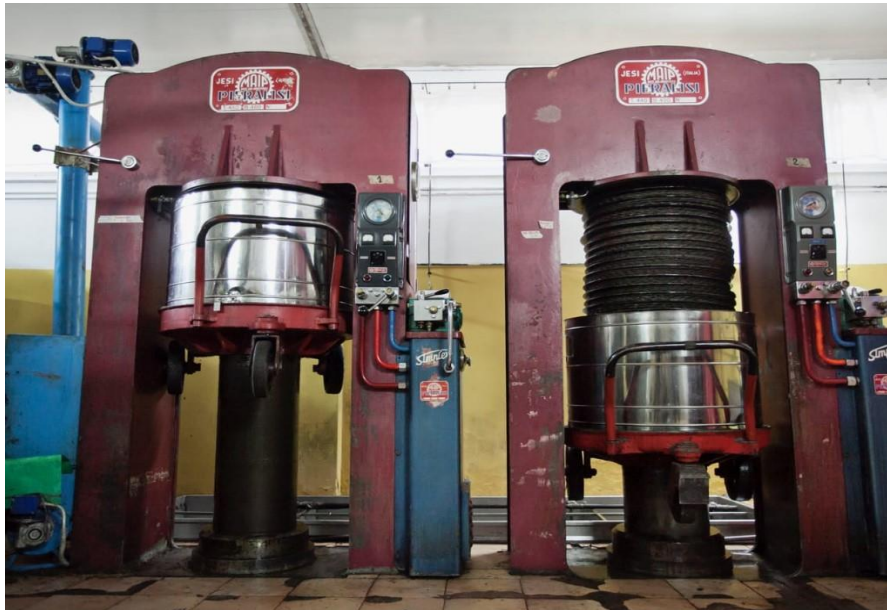
Figure N° 15 : Presse à huile d'olive traditionnelle (loc. San Felice 06030 Giano dell'Umbria)
