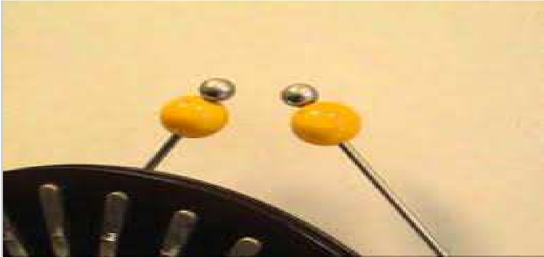
Figure. I- 9 : Claquage dans l'air entre deux sphères [2,10]
