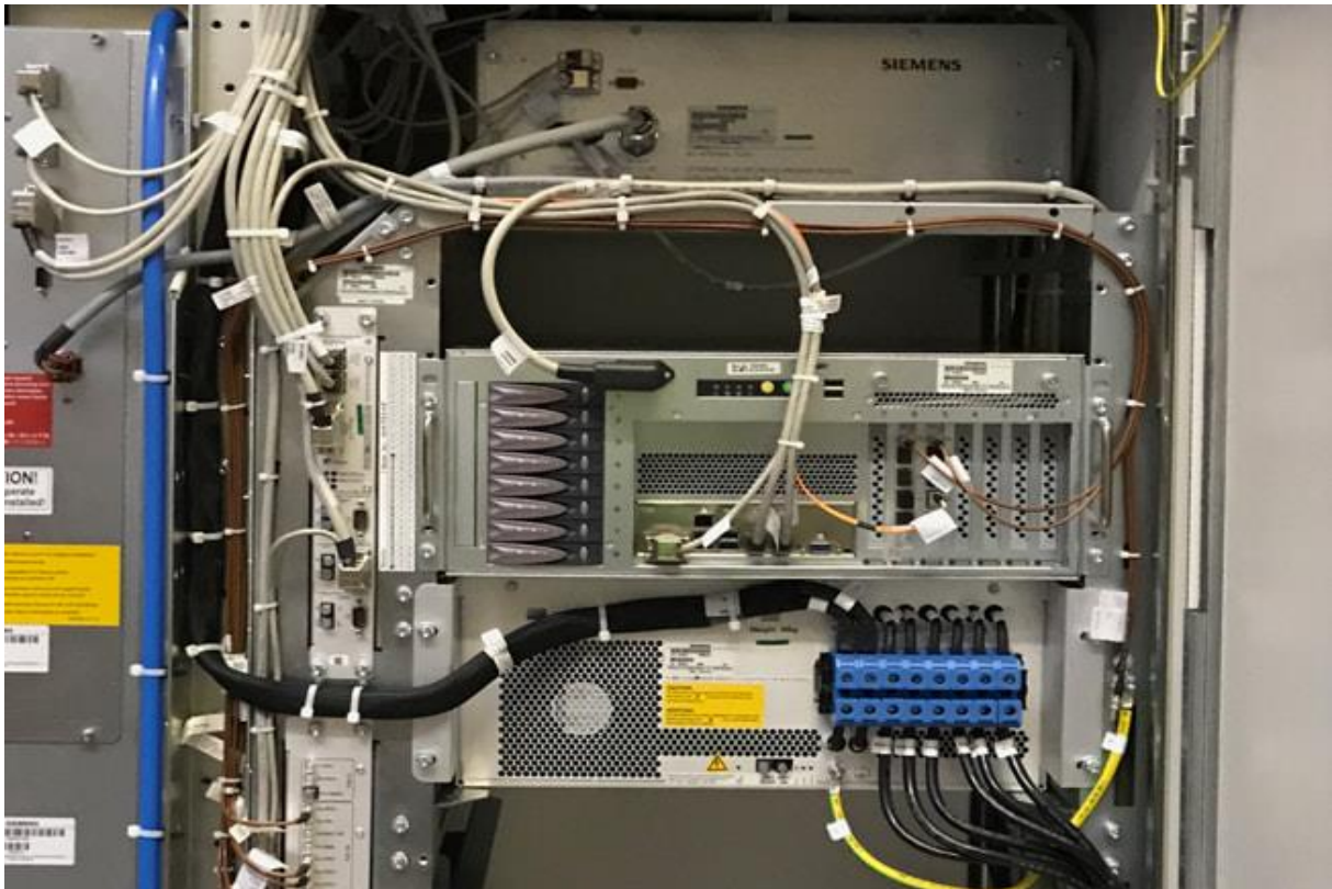
Figure II.5 : Le processeur matriciel, où s'effectue le traitement numérique des données IRM, y compris la transformation de Fourier.
