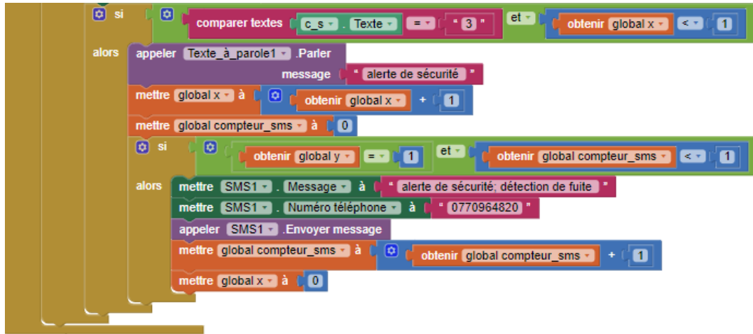
Figure 4.20 : Blocs pour envoi d'un SMS d'alerte à un téléphone enregistré sous App Inventor.
