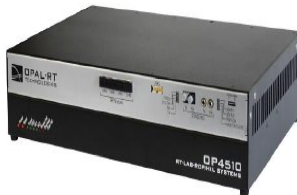
Figure I.24 : Vue frontale du simulateur + Architecture de l'OP4510 [4].
