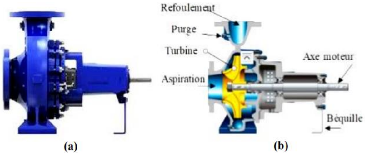
Figure 4.1 : (a) Pompe centrifuge accouplée MAS, (b) coupe longitudinale.
