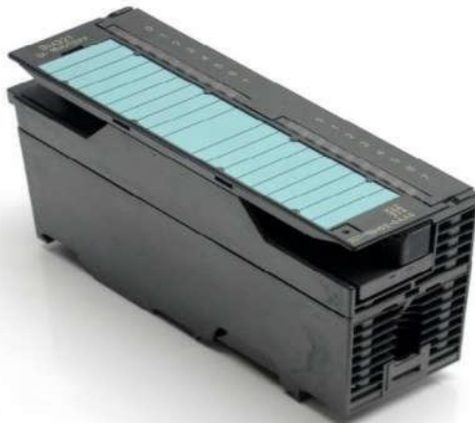
Figure. 2. 7 : Un module SM de S7-300.
