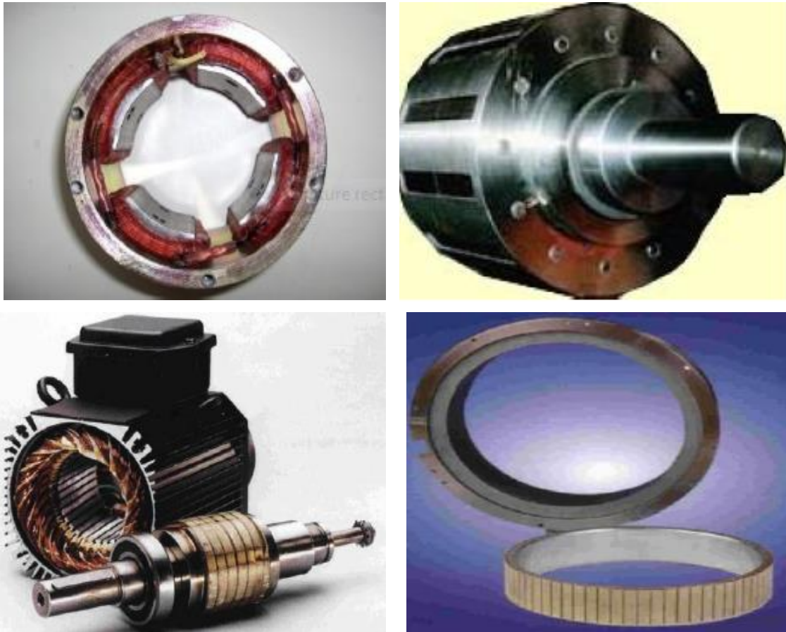
Figure (2.1) : Photographie de moteur à aimants en géométries cylindriques
