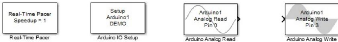
Figure 7 – Les Blocs d'ArduinoIO nécessaires pour la commande
