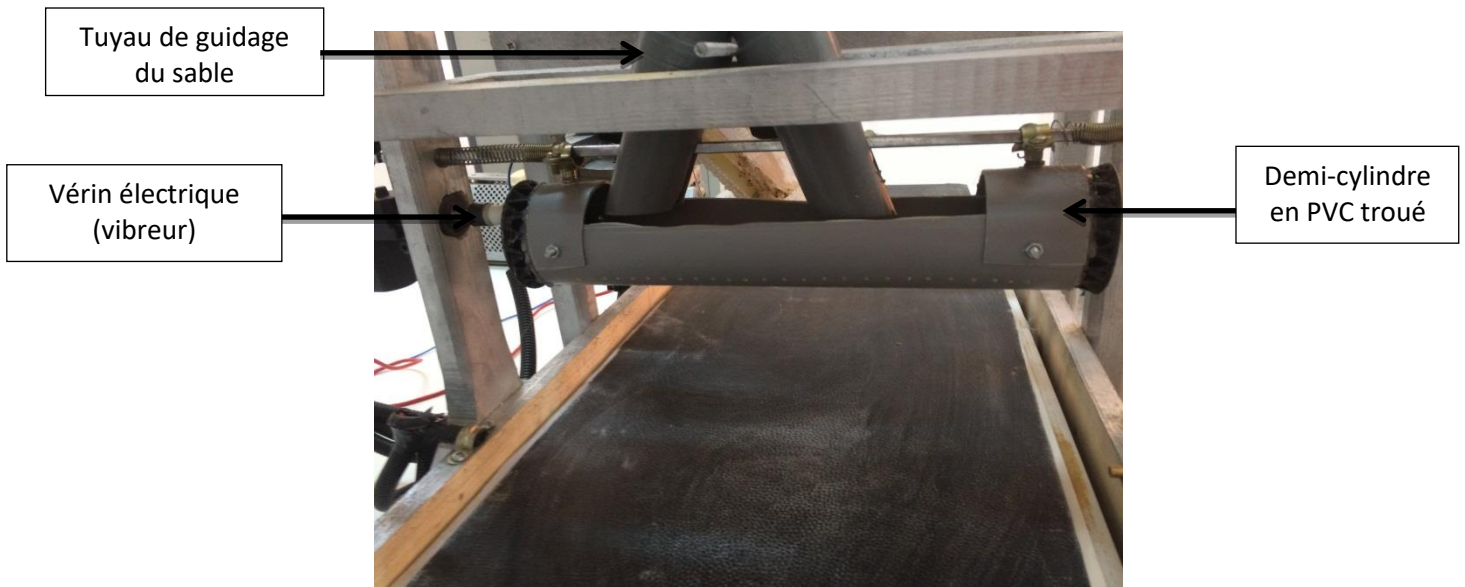
Figure III.11 saupoudreuse de sable après l'assemblage
