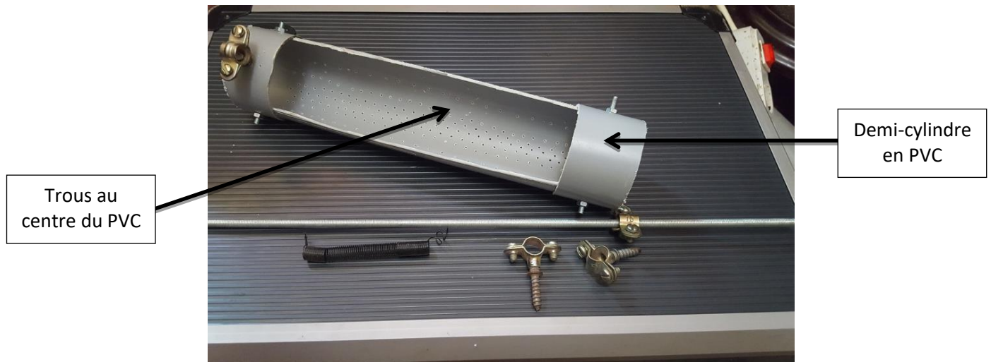
Figure III.10 Cuvette du sable après l'assemblage
