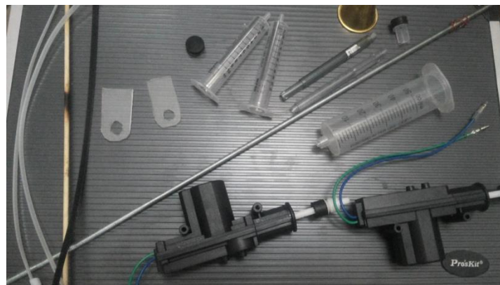
Figure III.6 Éléments constituant l'injecteur de couleur avant l'assemblage
