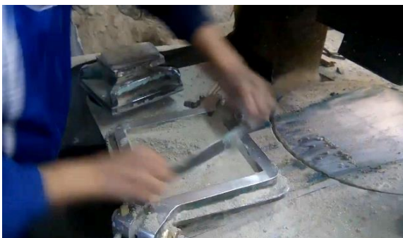
Figure I.11: Etape 4 Remplissage au mortier gris et Passage à la presse) [9]
