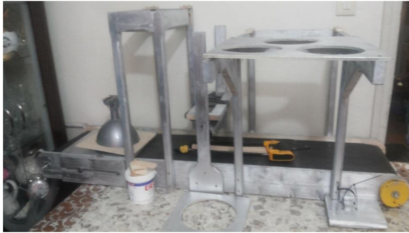
Figure III.3 Cadre du prototype après l'assemblage
