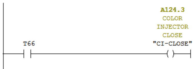
Figure IV.20 Réseau fermeture de l'injecteur couleur
