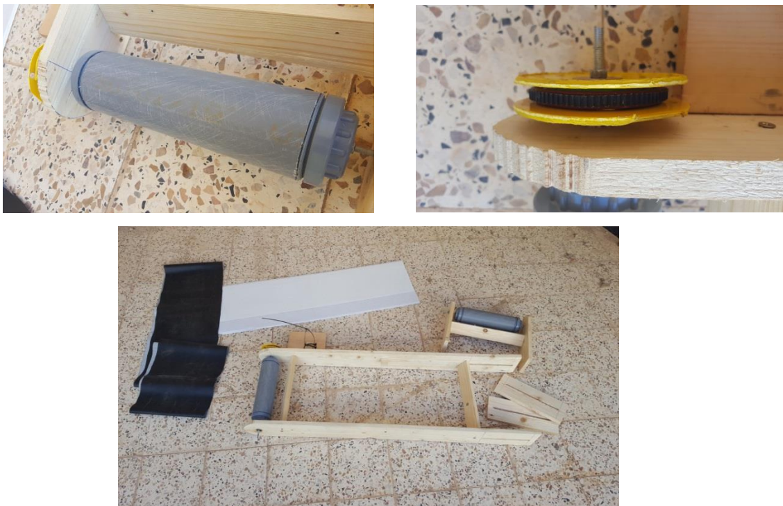
Figure III.4 Éléments constituant le convoyeur avant l'assemblage
