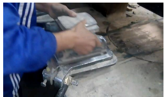
Figure I.11: Etape 4 Remplissage au mortier gris et Passage à la presse) [9]
