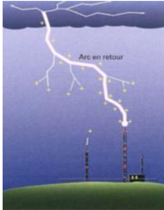
Fig. I-11 : Progression des traceurs suivis de l'arc en retour[3]
