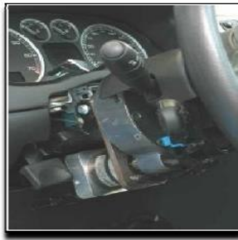
Figure .I.1 Moteur électrique installé sur la colonne de direction.
