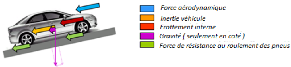
Figure. II.3 Les forces de résistance à l'avancement de véhicule
