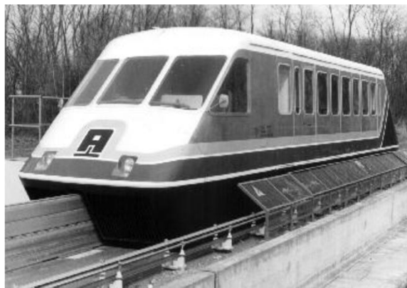
Fig. 1.2 : L'aérotrain suburbain S44.
