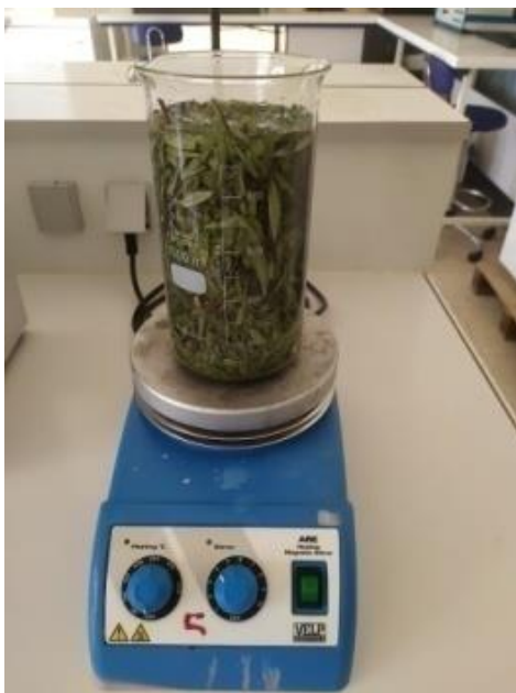
Fig. 16 : Photos montrant l'extraction par macération.
