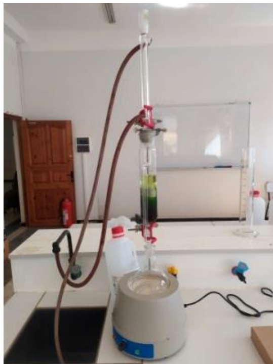
Fig. 17 : Photos montrant l'extraction par soxhlet.
