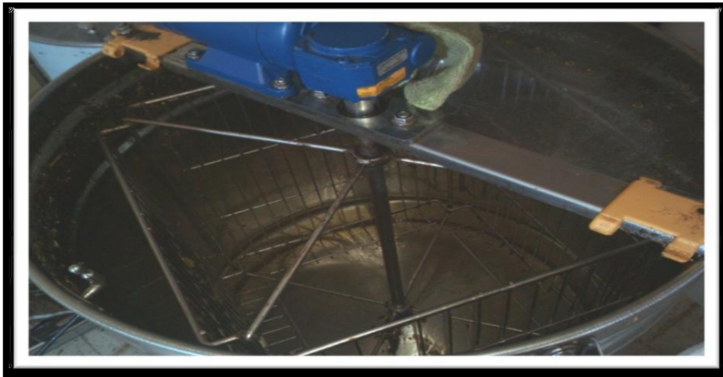
Figure N°19 : processus par cette machin l'extraction de miel
