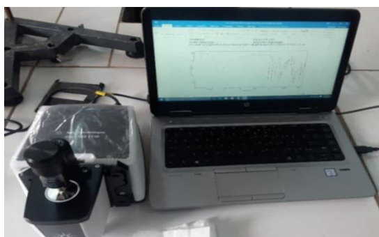
Figure I.9: Appareil de l'infrarouge Agilent technologies Cary 630 FTIR
