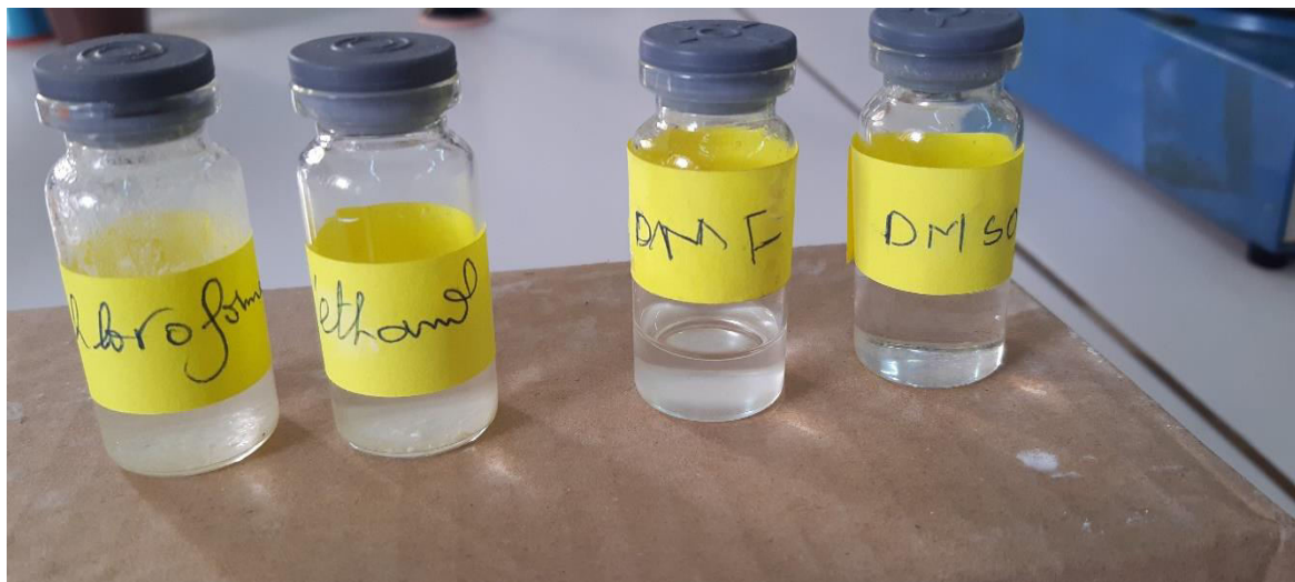
Figure I.43 : Test de solubilité du TPA produit par glycolyse
