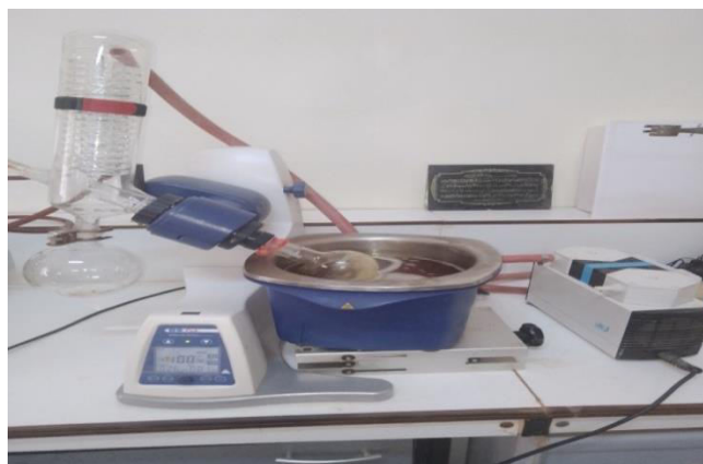
Figure I.18: montage de Distillation sous pression« Rota-vapeur».
