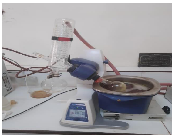
Figure I.28 : Montage de Rota-vapeur (distillation sous pression)
