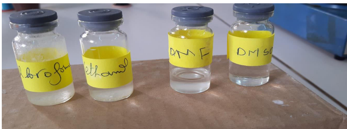
Figure I.26 : Test de solubilité du TPA produit par glycolyse
