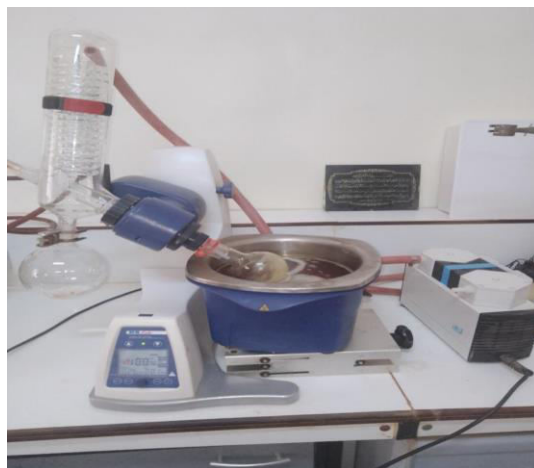
Figure I.5: Montage de distillation sous pression « Rota-vapeur »
