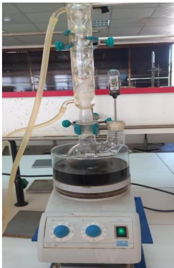
Réaction à reflux de l'Aminolyse
