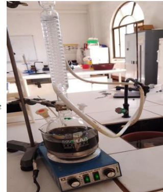
Réaction à reflux d'Hydrolyse
