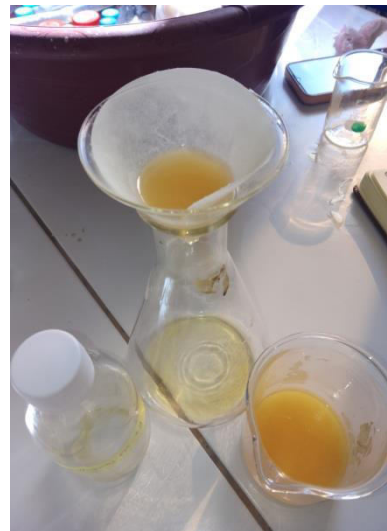
Filtration avant la neutralisation
