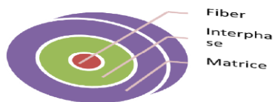
Figure I.12 : L'interphase d'un composite
