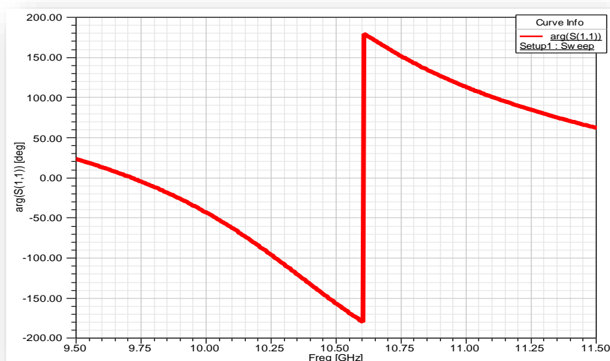
Fig III.8 : Réponse en phase du résonateur volumique pour le dimensionnement du facteur de qualité.
