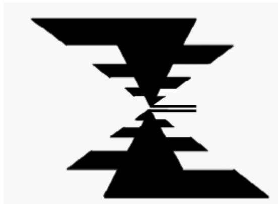
Figure II.9: Antenne spirale à forme trapézoïdale.
