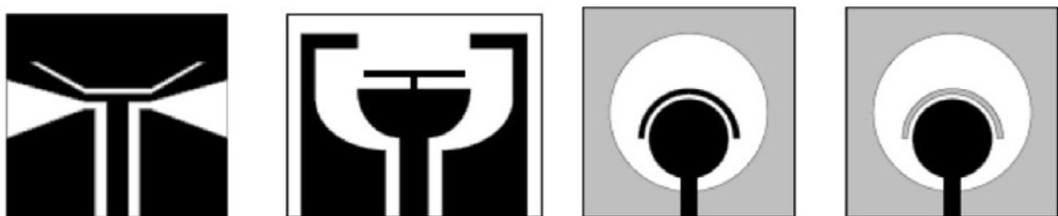
Figure II.22: Antennes UWB à fréquence rejetée par utilisation de fentes à proximité de l'élément rayonnant.
