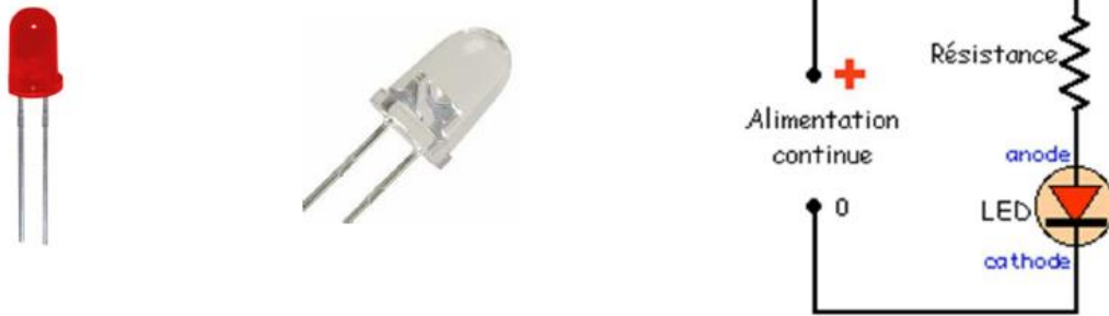
Figure(III.9) Montage électrique à LED.
